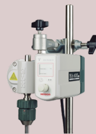
実験室用攪拌機 スリーワンモータ
