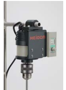
BLW3000 モータに直接チャックが 付くギアレス機構採用
