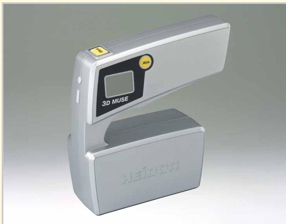
HEIDONトライボギア3DミューズTYPE:37i は、あらゆる物体の表面のすべり具合を測定できるポータブルタイプの測定機です。静摩擦の測定方法は、傾斜法やストレインゲージを使用する方法から、対象物の平面に置くだけで測定できる「ミューズTYPE:94i-II」へと進化。そして「3DミューズTYPE:37i」では、水平面のみならず傾斜面、壁面、天井面などのあらゆる面を測定でき、経験を要求しない簡易な操作と多角度の測定時におけるグリップ時の安定性と重量バランスが進化した摩擦計です。
