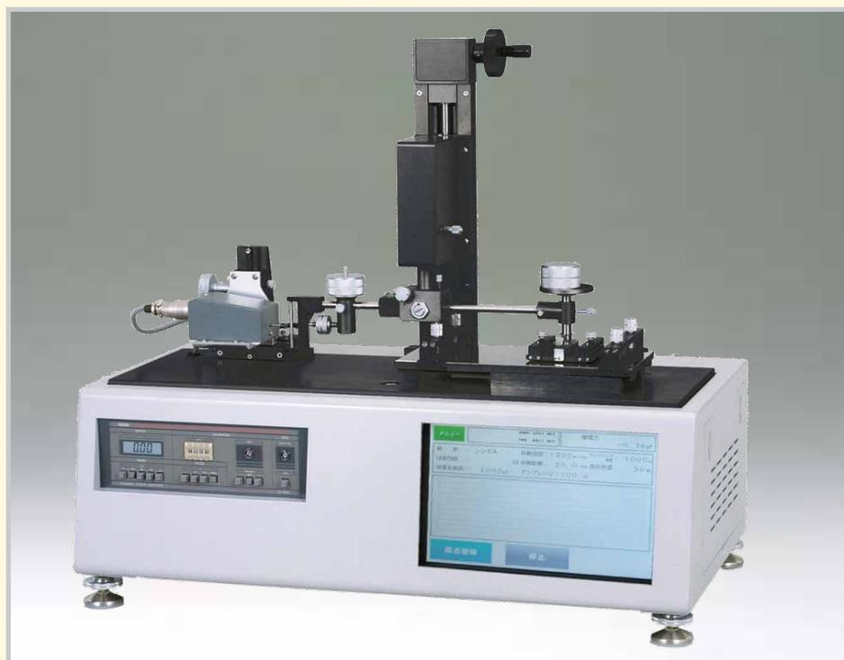
幅広い試験に対応した摩擦摩耗試験機です。テーブル速度、移動距離、往復回数を設定することができますので、様々な条件下で試験が可能です。また、それらの設定はすべてタッチパネルで操作できますので複雑な操作方法を習得する必要はありません。また、接触部のアタッチメントを様々に交換することができますので、摩擦摩耗試験における接触形態の変更だけではなく、引掻強度、剥離抵抗試験を行うことも可能です。さらに、オプションのトライボソフトを使用すればデータの管理、解析を簡単に行うことができます。
