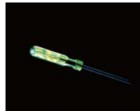
プラスチック成型品の歪み
