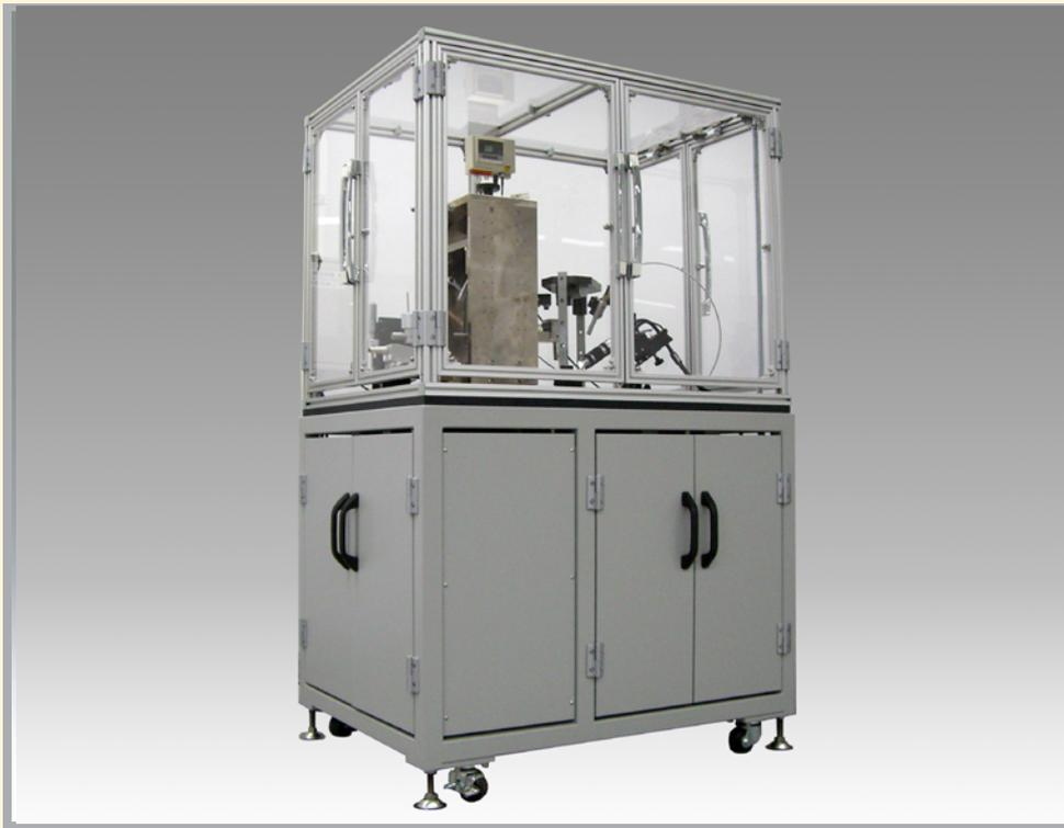
20gから最大100Kgまでの広域荷重範囲を実現した、摩耗試験機です。これ一台で幅広い荷重域の摩耗実験が可能です。回転式ターンテーブルの採用により低速から高速で摩耗実験を行えます。さらに摩耗現象を観察できるCCDカメラトライボシステムもご用意しましたので、安全に正確に摩耗現象を把握できます。
